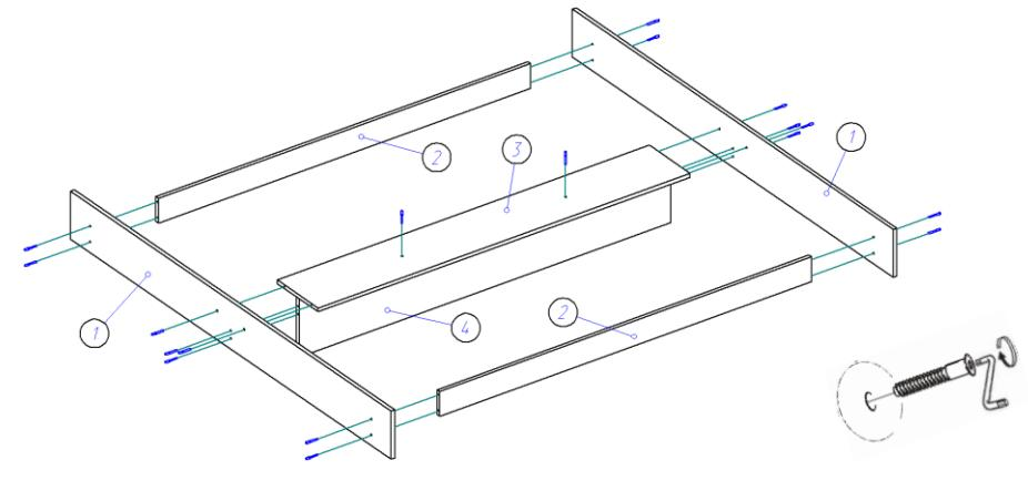
2. Гвоздями 1,2\*20 к изголовью (6) и изноожью (5) прибиваем подпятники. Евровинтами крепим планки (7) к царгам (1) и распоркам (2), после чего изголовье (6) и изноожье (5) евровинтами крепим к планкам (7) и царгам (1). Укладываем настилы, производим дополнительную фиксацию настилов саморезами 4\*30. Принцип сборки одинаков для разных конфигураций изголовья.
